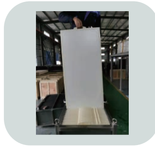
更换平板膜元件 Replace flat-sheet membrane unit
